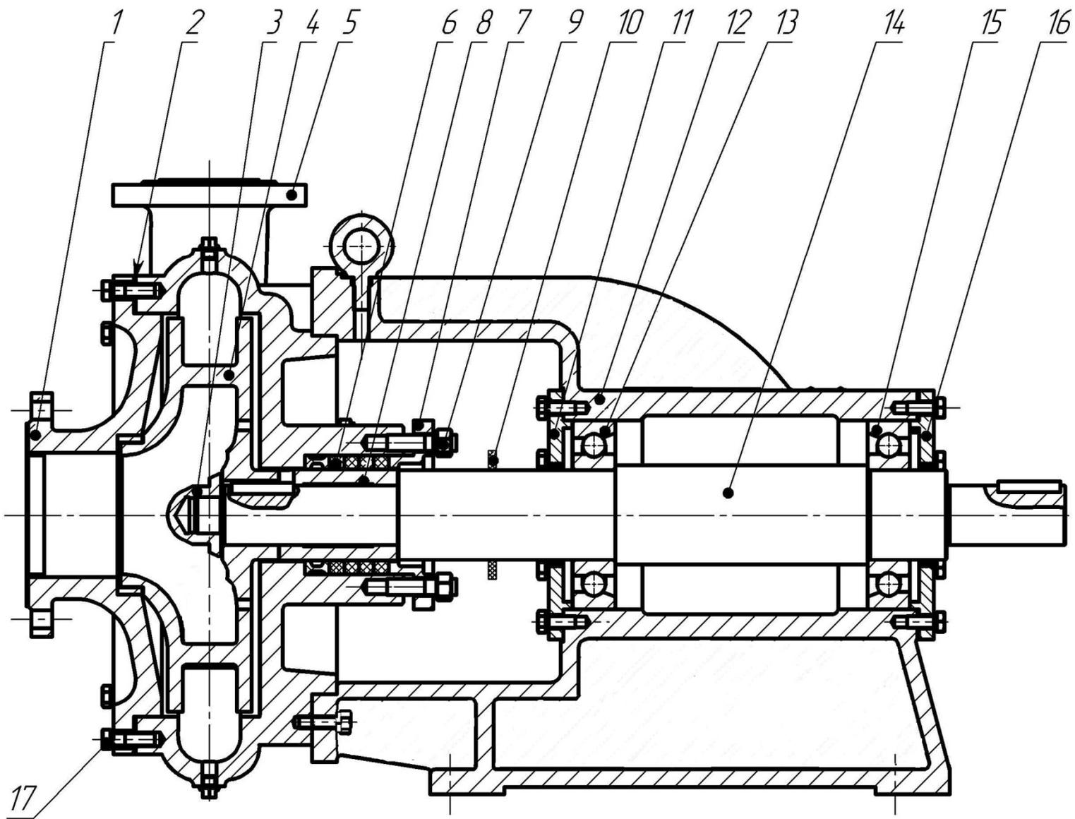
Рисунок 3-Разрез насоса
